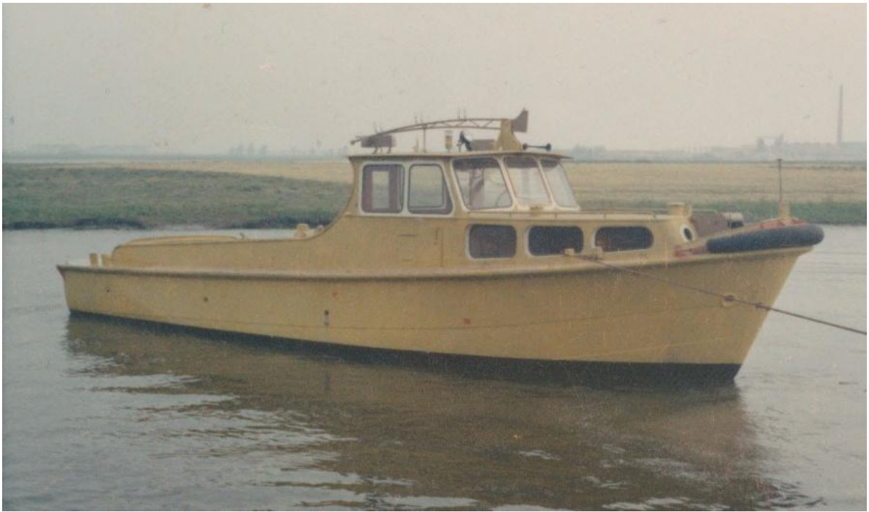
Werkboot, nog in de gele zinkchromaat grondverf, bestemd voor de Rotterdamse haven en werk op de Maas. 1965 Naar een idee van Tonny Brugman.
