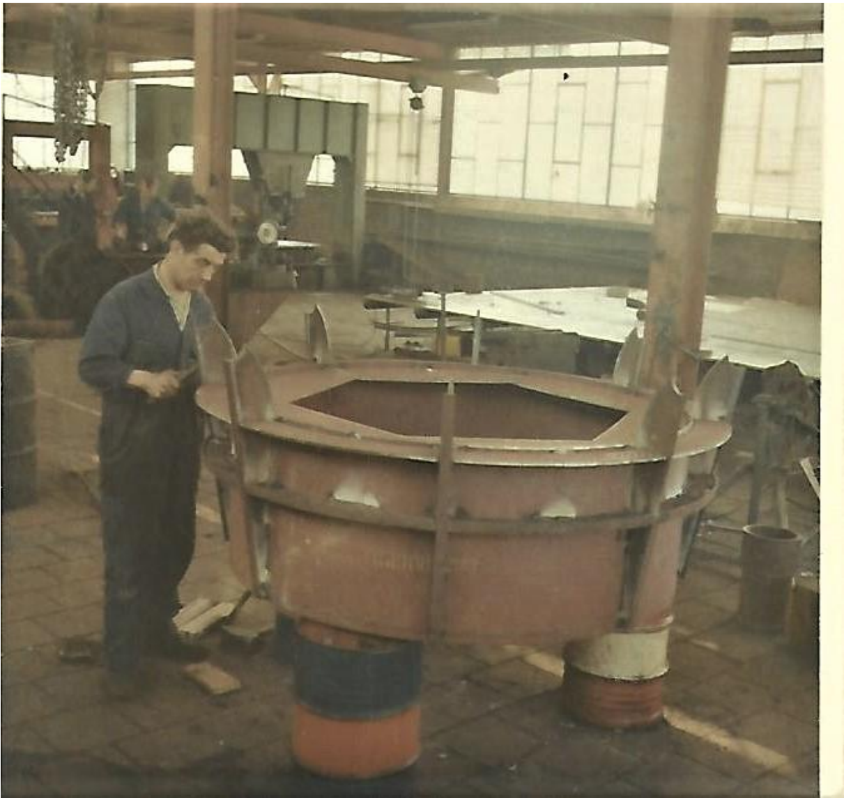
Dolf Geurts, lassend aan de schroeftunnel voor sleepboot met rode opbouw. Foto genomen in de werkplaats aan de Nijverheidstraat rond 1967
