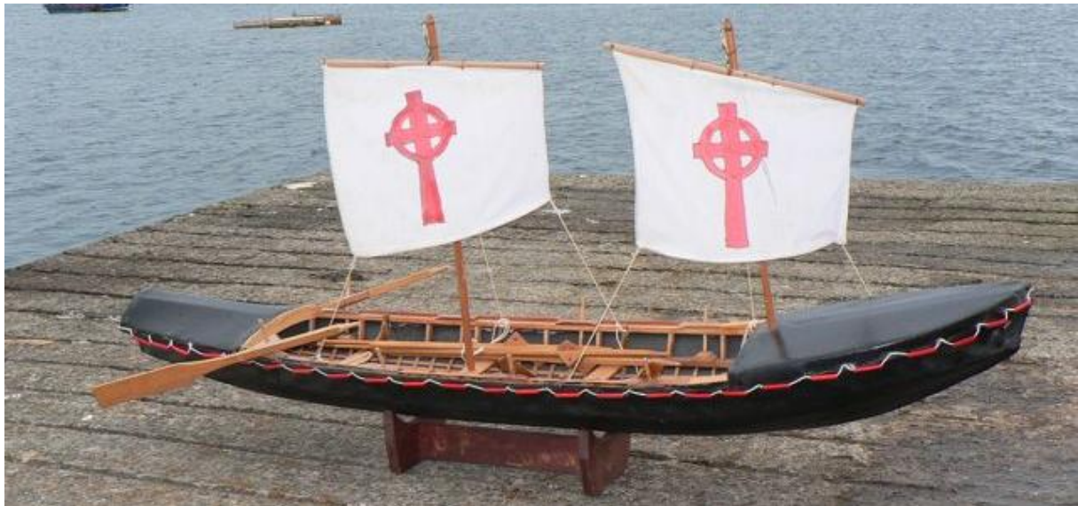
Replica van Brandaans curragh, tegenwoordig overtrokken met canvas en ingesmeerd met teer. Merk op dat er twee roeren zijn.
