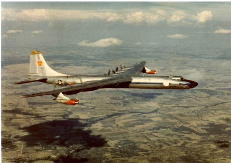
De Convair NB-36H. Vliegende testplaats voor een met kernenergie aangedreven vliegtuig. Het zou wekenlang, zonder bijtanken, boven de Sovjet Unie rond hebben kunnen vliegen.
