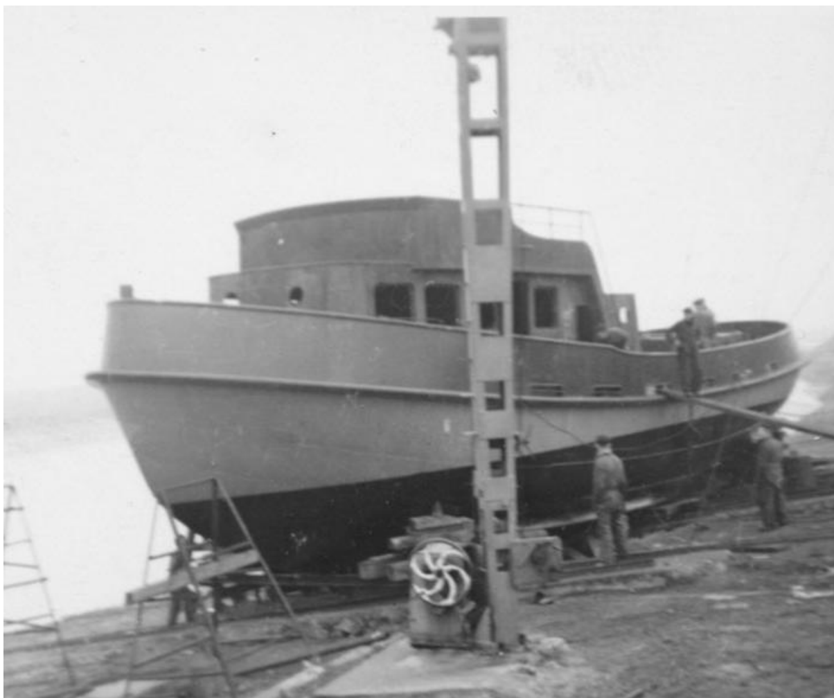
Casco van de riviersleepboot "Albert II" bijna gereed op de helling aan de Dijk.
